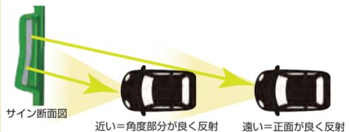
サイン断面図 近い=角度部分が良く反射 遠い=正面が良く反射
